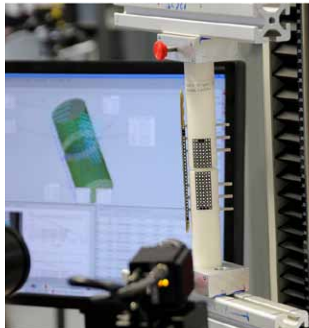
Foto: Testumgebung für Dynamic Locking Screw. rechts: Modell einer Fraktur, links: Bildschirmdarstellung
