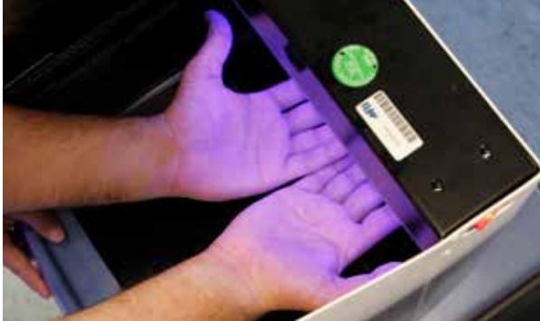
Schonungslos zeigt die UV-Lampe, welche Hautstellen nicht mit Desinfektionsmittel erreicht wurden.
